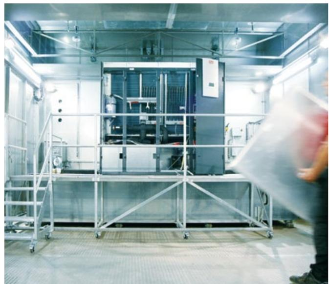
Innenabmessungen der Klimakammer: Höhe 4180 mm, Breite 9760 mm, Tiefe 5680 mm
