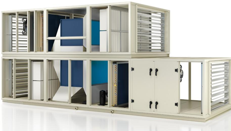
In sehr heißem Klima erhält das vorhandene System eine zusätzliche DX-Kühlung. Das komplette DX-System mit Kompressor, Verdampfer und Verflüssiger ist ebenfalls im Gerät untergebracht. Durch diese Option können 30 % der erforderlichen Kühlung mechanisch erzeugt werden. Dadurch ist das System praktisch in jeder Klimazone einsetzbar.
